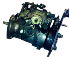
Vorher und nachher. Reinigung der einspritzpumpe
