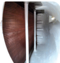
Prima e dopo. Pulizia intercooler e motore mtu
