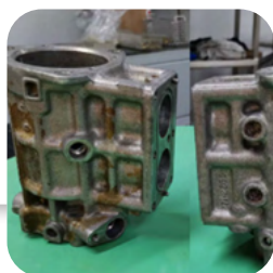
Prima e dopo. Pulizia testa e trave tubolare
