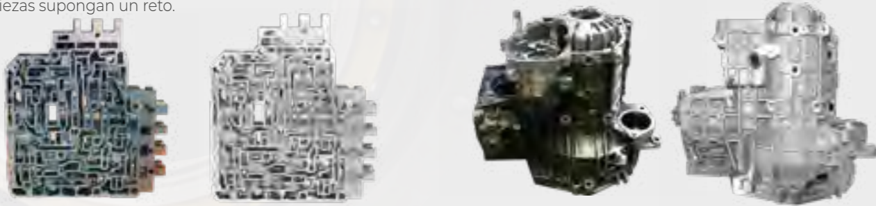
ANTES Y DESPUÉS. LIMPIEZA DE CAJA DE VÁLVULAS Y DE CAJA DE CAMBIO
