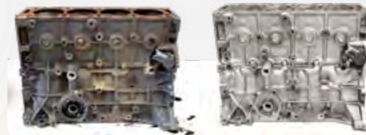
ANTES Y DESPUÉS. LIMPIEZA DE CULATA DIÉSEL Y BLOQUE DE MOTOR
