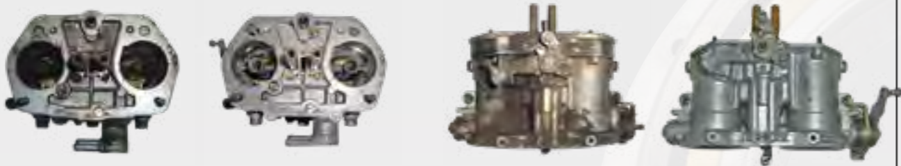
ANTES Y DESPUÉS. LIMPIEZA DE CARBURADOR
